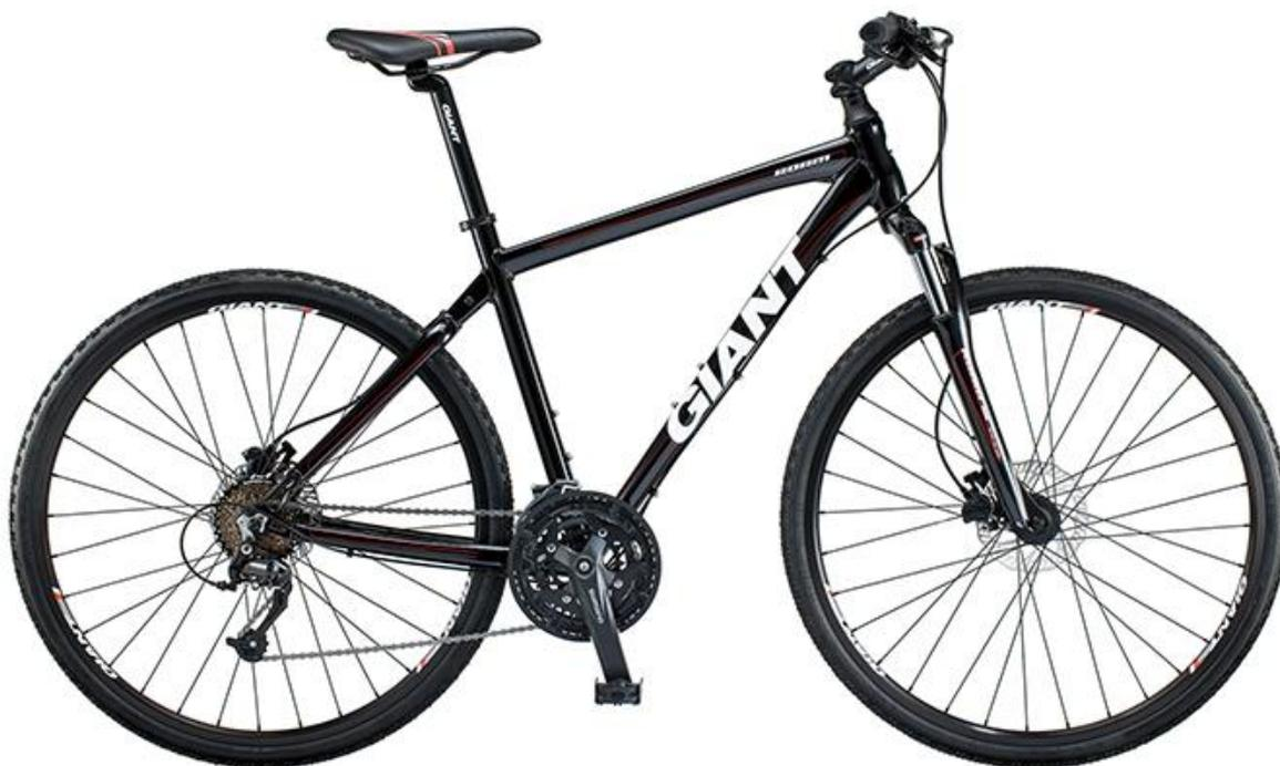
Cadre en aluminium ALUXX léger, solide et fiable et à défilement rapide grâce à des roues de 700c de diamètre, le ROAM vous encouragera à faire de longs trajets. Avec une suspension pour absorber les surfaces rugueuses, elle peut être verrouillée pour les revêtements doux.
