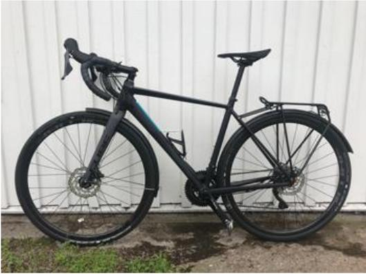
Cadre d'aluminium, fourchette de carbone, freins hydrauliques à disque, 22 vitesses. Casette ; Shimano 105, garde-boues, porte-bagages, lumière avant et feu arrière, poids total : 11,7 kg.
