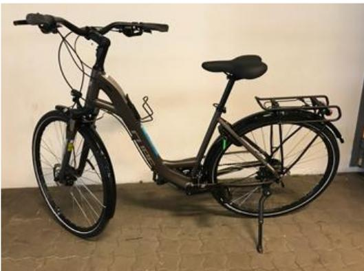
Vélo de femme : Cadre d'aluminium avec un simple entrée, idéal pour une position de conduite droite mais détendue, 27 vitesses, freins à main (freins à disque)
